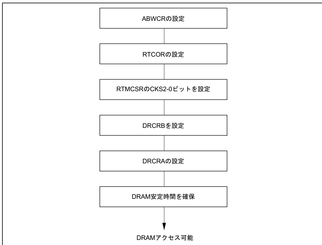
図 6.34 DRAM インタフェースの使用時の設定手順例
