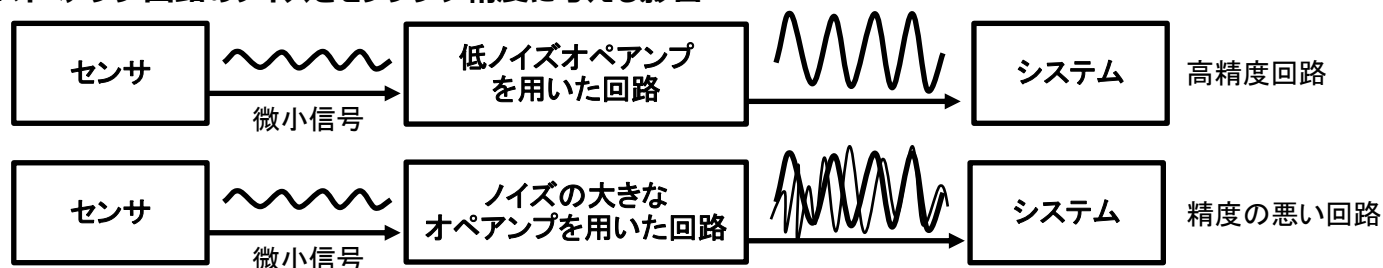
図 3.1.1 オペアンプ回路のセンシング精度に与える影響
